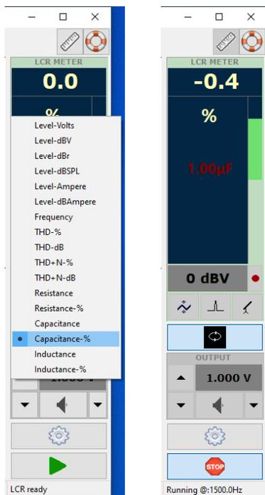
In questa modalità il multimetro mostra la deviazione in percentuale rispetto ad un valore di riferimento. Il valore di riferimento può essere impostato direttamente dal multimetro cliccando sul valore della lettura corrente, nel nostro caso 1.02 uF. Alternativamente il valore può essere impostato dal menu di selezione delle impostazioni di Clío Pocket sotto la linguetta "Meter":
