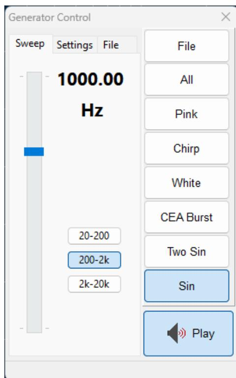
La frequenza generata viene controllata dal cursore e tramite i bottoni è possibile selezionare le tre bande di frequenza. Normalmente il cursore opera in modo grossolano spazzando l'intera banda di frequenza selezionata, premendo il tasto CTRL si passa ad una modalità di controllo più precisa nell'intorno del  $\pm 1\%$  rispetto alla frequenza selezionata.
