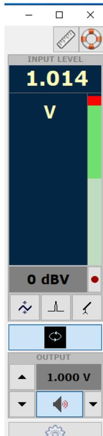
Se tutto è corretto dovreste ottenere una lettura di circa 1V, variabile tra un minimo di 0.950V ed un massimo di 1.050V, che è il livello medio di uscita di un segnale sinusoidale quando il sistema non è calibrato.
