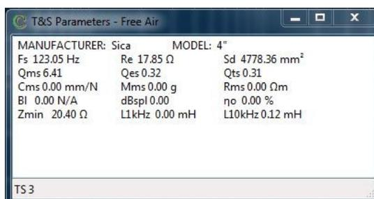
Per arrivare ai parametri completi caricate la misura di impedenza con massa aggiunta, tornate su Option Dialog
