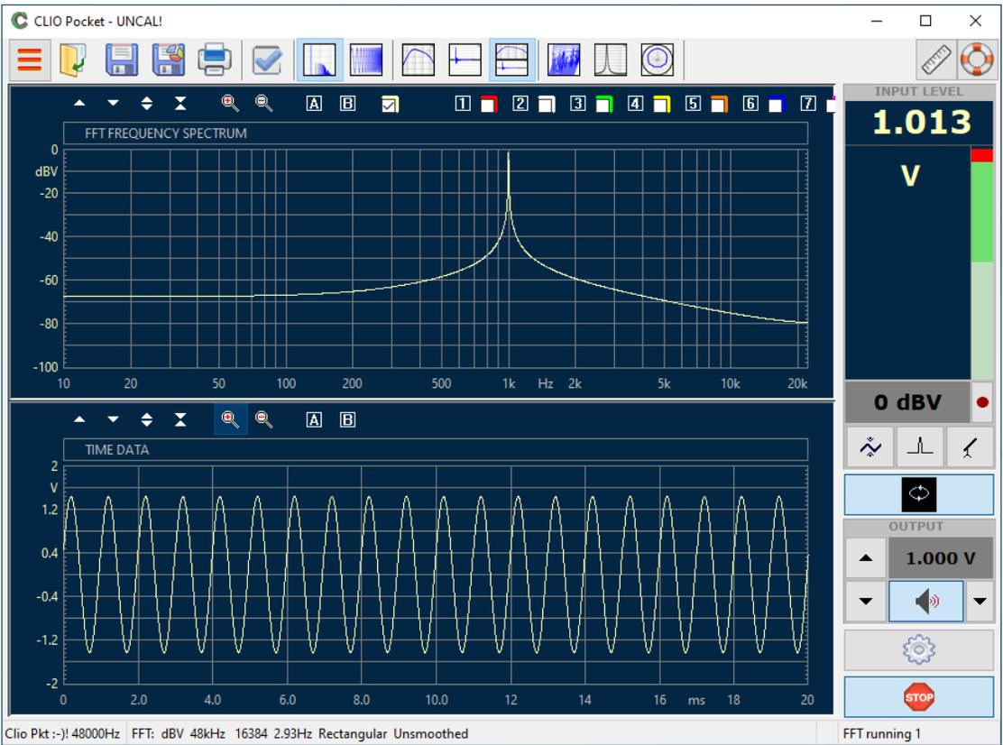
Come risultato si dovrebbe ottenere l'analisi FFT della sinusoide ad 1kHz insieme alla sua rappresentazione come forma d'onda.
