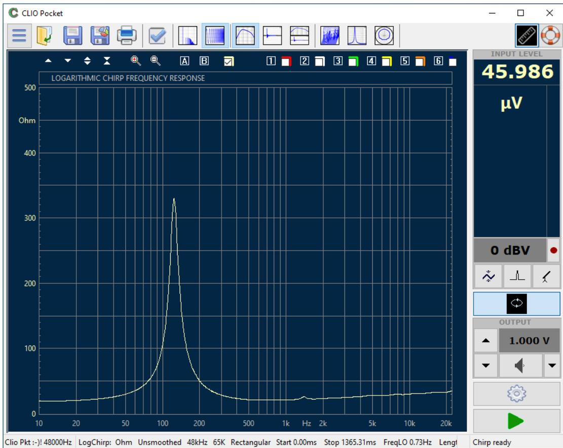
Naturalmente la vostra sarà diversa ma di andamento simile. Potrà essere necessario aggiustare la scala della Y manualmente o con il bottone di AutoScale. Il perché si sia cambiata la scala in Ohm dovrebbe essere ovvio. Il cambio del numero di punti di acquisizione e della relativa FFT porta ad una aumento della risoluzione a bassa frequenza. Questo è desiderabile nel caso di woofer e midrange.
