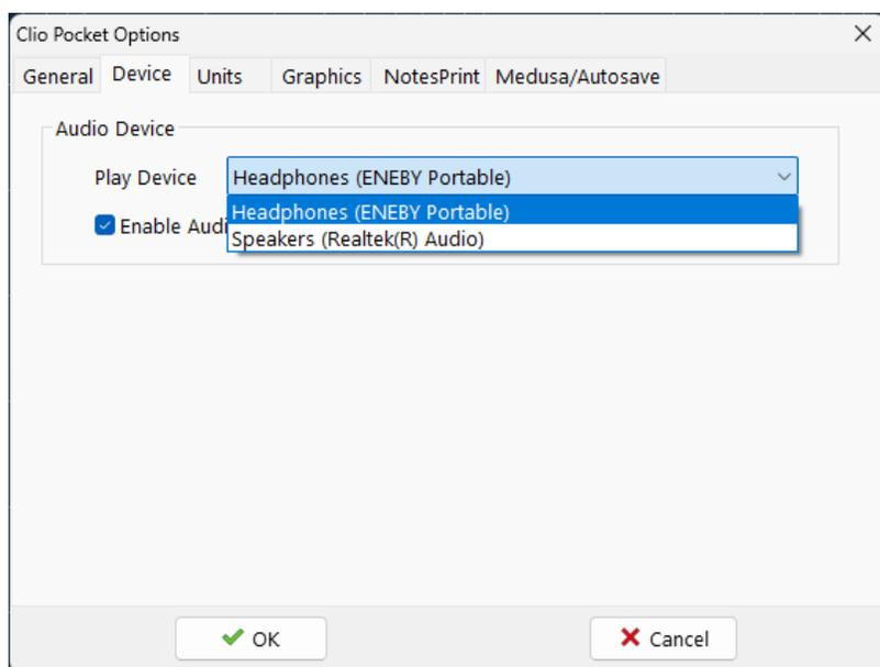
A questo punto ogni segnale generato da CLIO Pocket sarà inviato tramite l'audio del computer al dispositivo Bluetooth.
