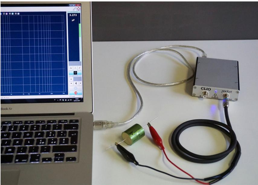
Selezionando le opportune unità di misura nel pannello del Level Meter (Resistenza Capacità Induttanza) e premendo la freccia di start ► dovrebbe partire la misura che si aggiorna in tempo reale come per le altre grandezze.
