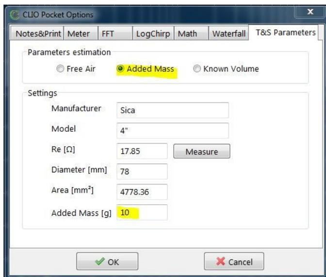
Dopo aver dato OK premete di nuovo il bottone T&S Parameters
