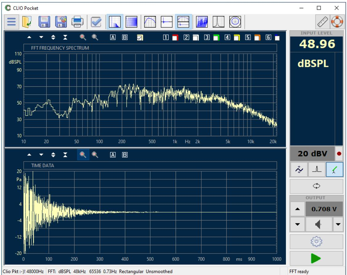
E' interessante realizzare del post processing di decadimento sulla risposta acquisita. Apriamo la finestra di impostazioni, selezionate Waterfall. Impostate come Time Frequency Distribution CSD, Start Frequency 50Hz, Stop Frequency 10000Hz, Smoothing 1/3 Octave, Range 40dB, Number of Spectra 120, Time Shift 5ms.
