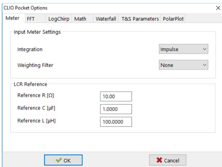
Una volta che il multimetro è impostato, la selezione dei componenti LCR diventa molto semplice, anche sulla base della deviazione in % dal valore di riferimento.
