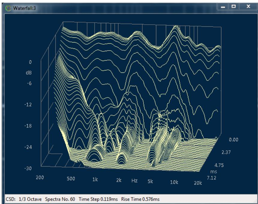
La CSD è un insieme di curve calcolate spostando progressivamente il punto di attacco della finestra di analisi dell'impulso e mantenendo costante la fine onde preservare la anecoicità. La presentazione viene fatta mostrando gli istanti temporali successivi di analisi.
