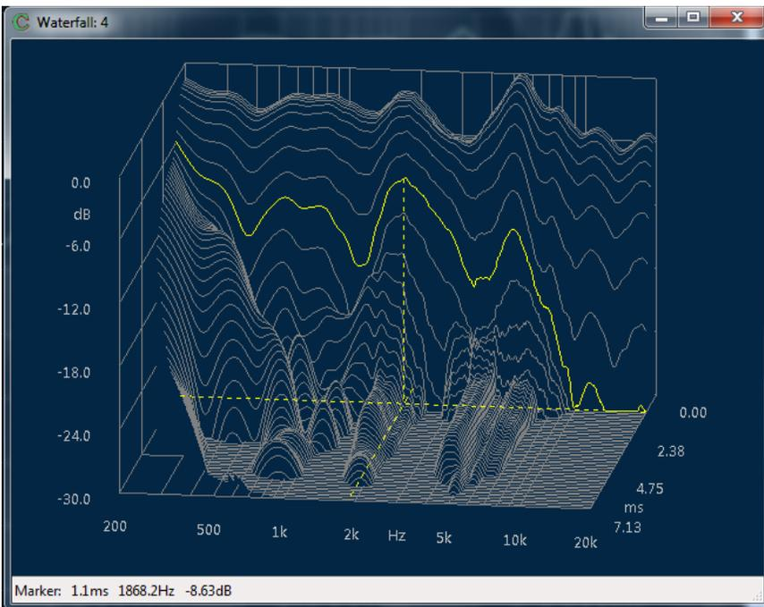
E' interessante guardare il decadimento delle risonanze in funzione dei cicli invece che del tempo tramite l'analisi WCD (Wavelet Cycle Decay) che utilizza la tecnica delle Wavelet applicata al decadimento dell'energia del sistema. In questo modo si enfatizza l'analisi delle alte frequenze dove la CSD tende a perdere di risoluzione. Si può interpretare il grafico come visualizzazione in funzione dei cicli del filtraggio della risposta con un banco di filtri passa-banda a Q costante.
