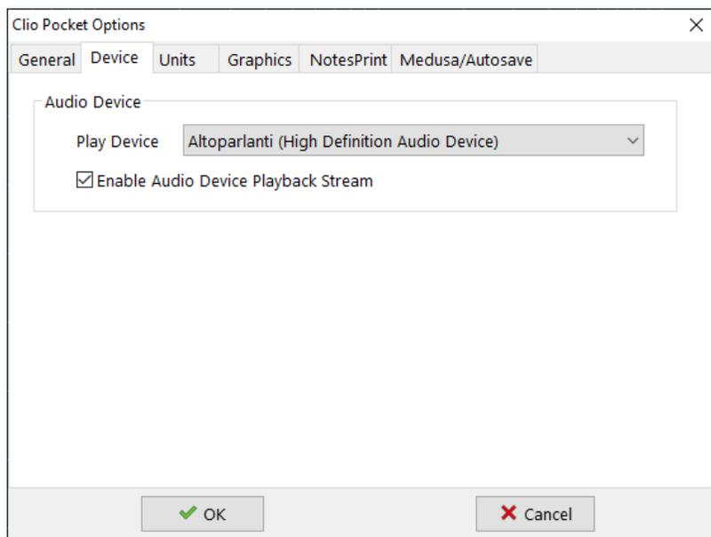
Questa opzione dunque permette di inviare la generazione dei segnali a qualsiasi dispositivo audio connesso al computer dove CLIO Pocket è in esecuzione. Ad esempio questo permette di collegare una cassa o una cuffia Bluetooth all'uscita audio del computer e di misurarne la risposta con CLIO Pocket.
