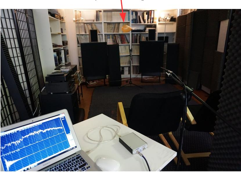
Andremo ad analizzare l'esplosione del palloncino che ci darà una misura della risposta all'impulso del nostro ambiente. Apriamo le impostazioni FFT, togliamo la spunta da RTA, impostiamo sia Event Trigger Enable (trigger sull'evento) che One Shot (una sola acquisizione), e inseriamo -5ms di pretrigger nel campo Delay.
