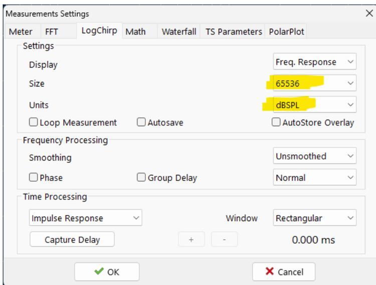
Al fine di rendere la riproduzione via Bluetooth stabile e tempo-invariante, almeno per il tempo necessario ad effettuare la misurazione LogChirp, è utile inviare un segnale pilota da riprodurre prima della misurazione vera e propria.
