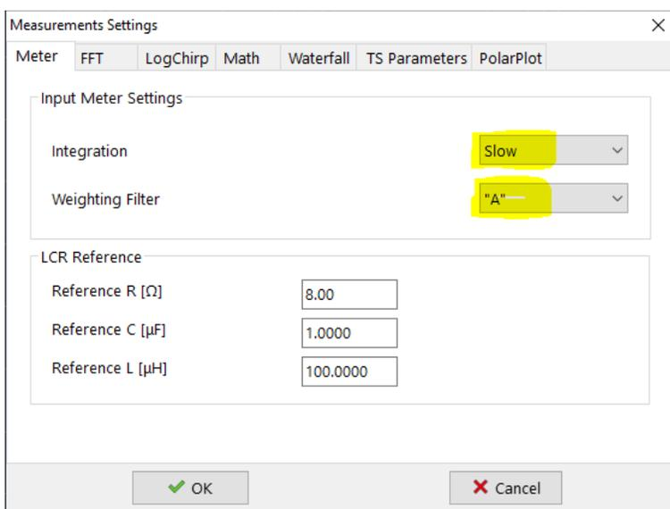
Impostiamo una Integration (integrazione) Slow e Weighting Filter (filtro di pesatura in frequenza) "A"; chiudiamo la finestra, dal menu principale selezioniamo dB SPL come unità di misura del Meter; premiamo infine il bottone FFT Go per iniziare la misura. Siccome il generatore è ancora spento dovremmo misurare il rumore fluttuante del nostro ambiente. Il Meter, che ora funziona come Fonometro, ci da una lettura in dBA (ovvero SPL pesati A).
