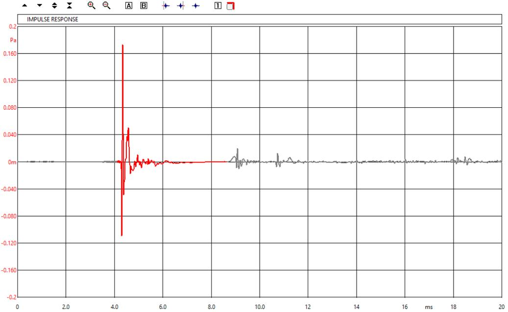
In questo caso è disponibile un singolo overlay. E' anche possibile **selezionare** una porzione della curva attiva tramite tre pulsanti particolari. La porzione selezionata della curva attiva è identificata da un punto di **start** ed uno di **stop** ed è visualizzata in un colore differente dalla parte non selezionata.
