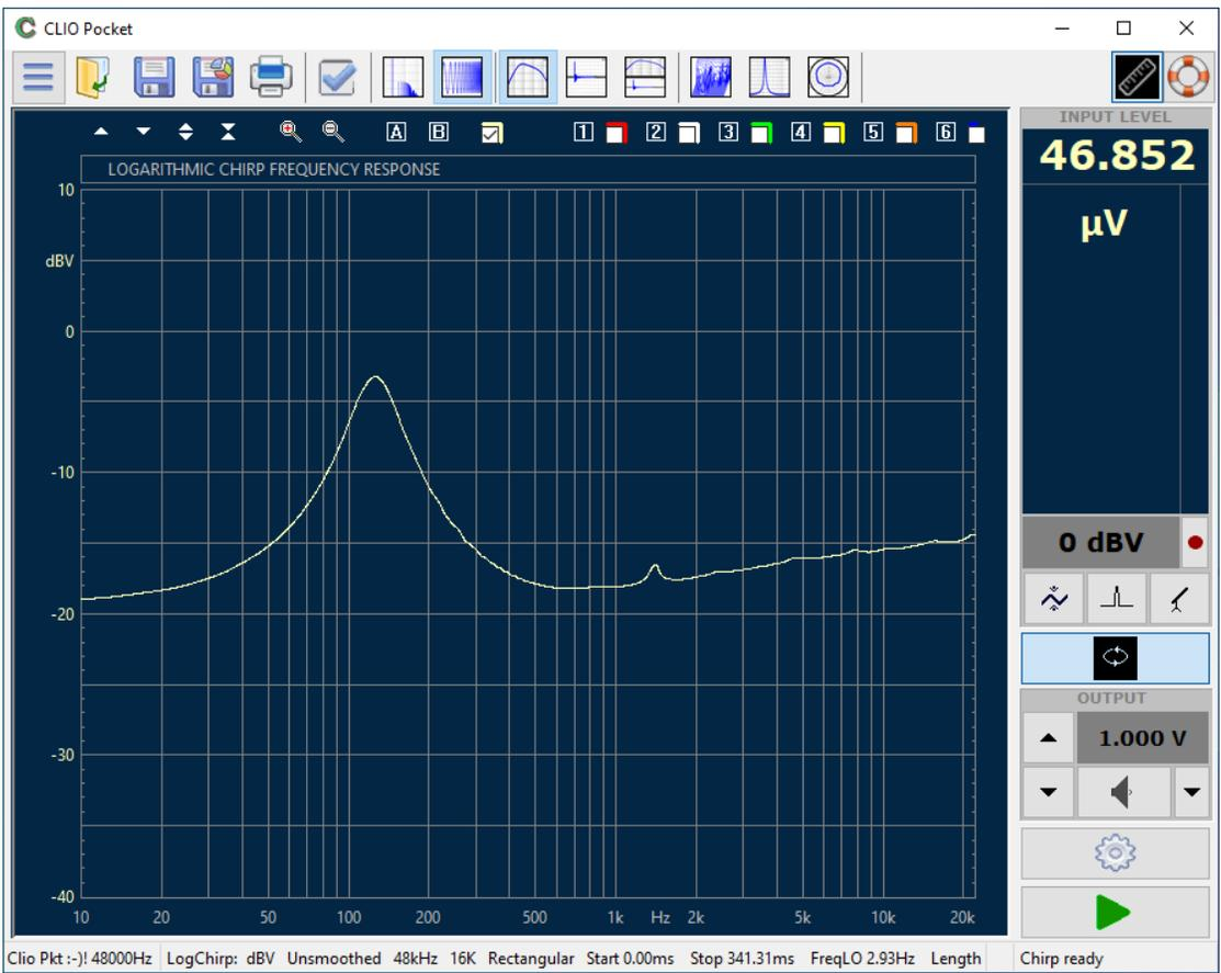
Di fatto non si tratta di una misura di impedenza ma di risposta in frequenza su scala logaritmica che mostra la divisione tra l'impedenza di uscita di CLIO e l'impedenza dell'altoparlante. Fate accesso al pannello dei Settings di LogChirp
