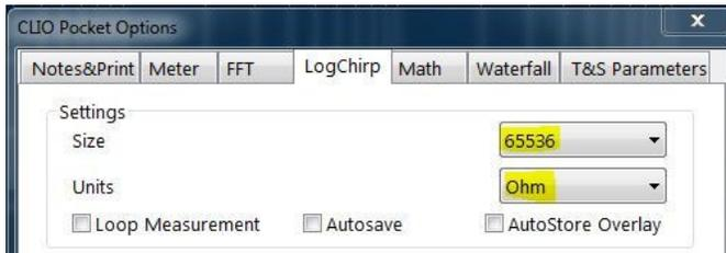
Ripetete la misura con i nuovi parametri. Dovreste finalmente vedere una misura d'impedenza:
