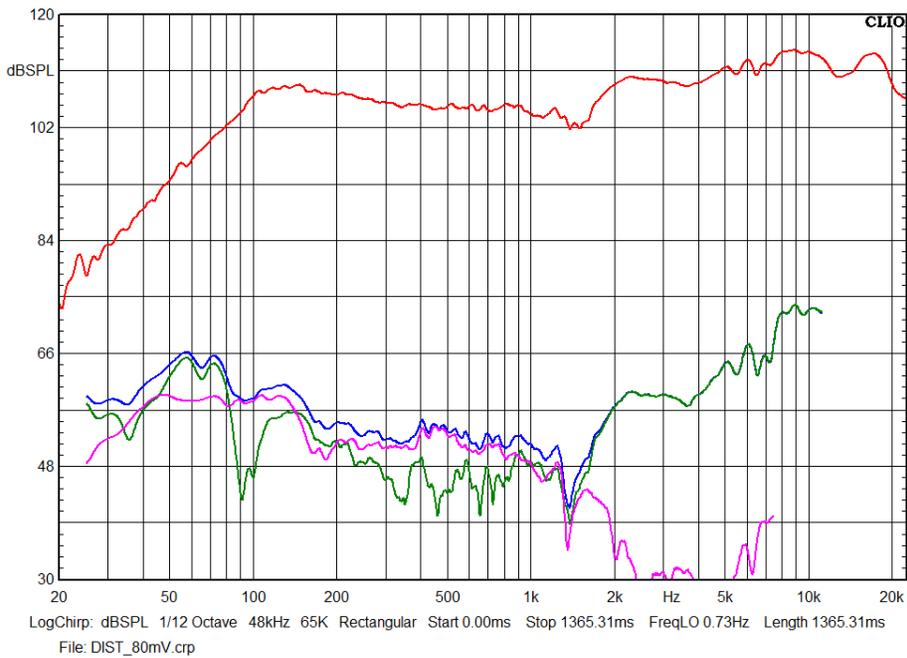
In alcuni casi di sistemi con bassa distorsione il livello delle componenti armoniche può essere molto basso e confondersi con il rumore di fondo della misurazione, che è in pratica il rumore ambientale presente. Quindi una distanza di misurazione limitata è utile anche nell'ottica di massimizzare il rapporto segnale rumore.
