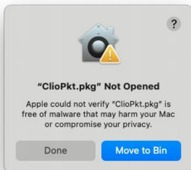
Nelle precedenti versioni di macOS il Click con tasto destro sull'icona del package di installazione di ClioPkt portava ad una finestra con messaggio simile, ma con un tasto "Open" che qui non è presente. Per procedere con l'installazione di Clio Pocket è necessario aprire System Settings e selezionare la sezione Privacy & Security.
