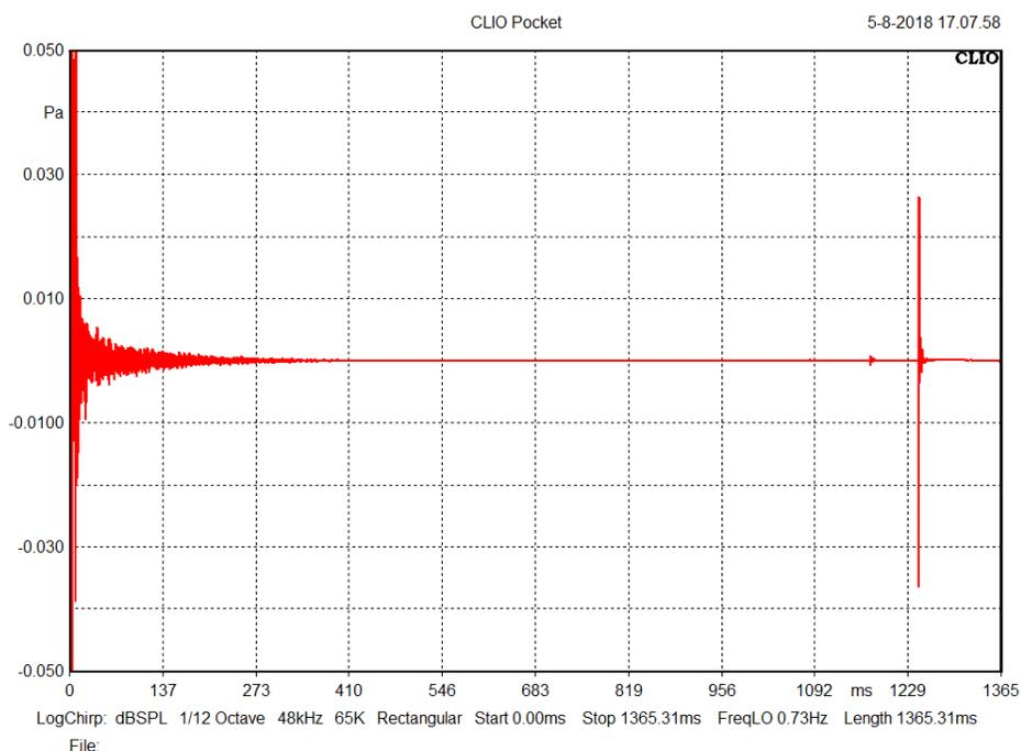
La risposta all'impulso delle componenti di distorsione è chiaramente visibile nella coda della risposta all'impulso misurata.
