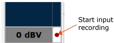
L'uso è semplice: la prima pressione del bottone far partire l'acquisizione, la seconda la arresta. Il tempo di registrazione trascorso è mostrato nella parte inferiore della finestra del multimetro:
