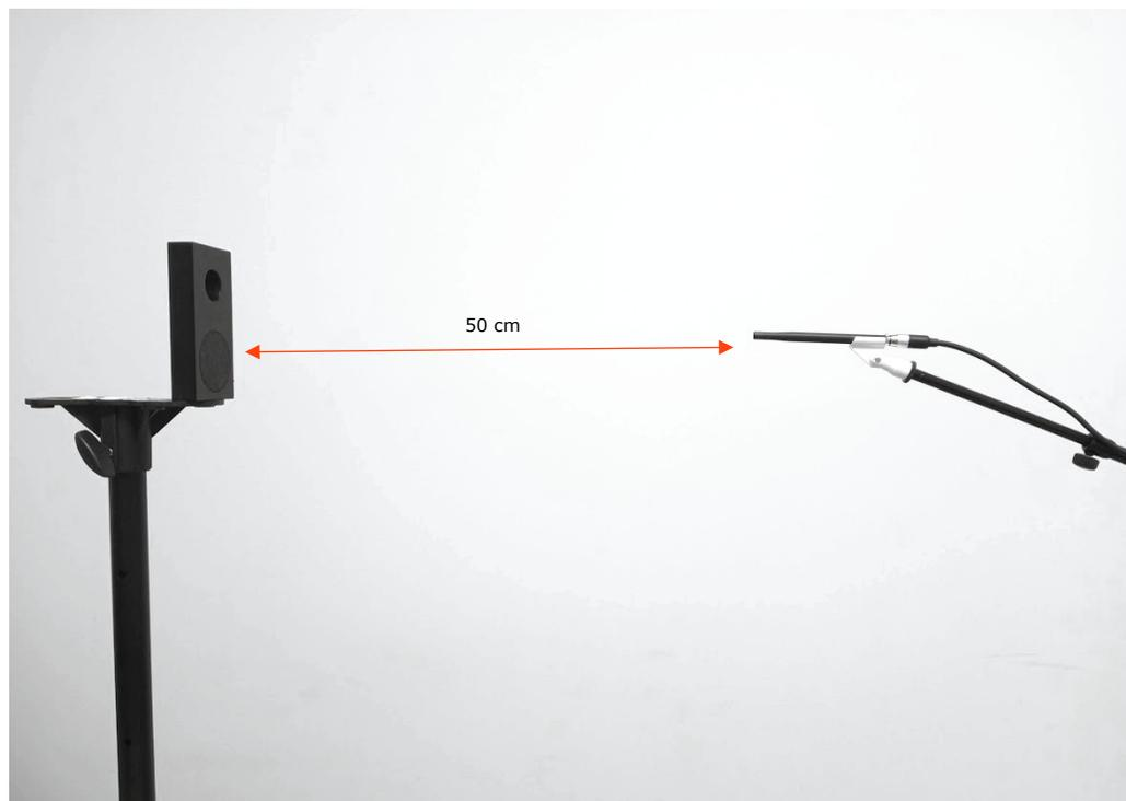
Iniziamo accoppiando l'altoparlante al computer. Una volta che il dispositivo è accoppiato e regolarmente visto come dispositivo audio di riproduzione dal computer, possiamo lanciare CLIO Pocket, aprire la finestra delle opzioni, abilitare Enable Audio Device Playback Stream ed infine selezionare il dispositivo tra quelli disponibili nella casella di selezione.
