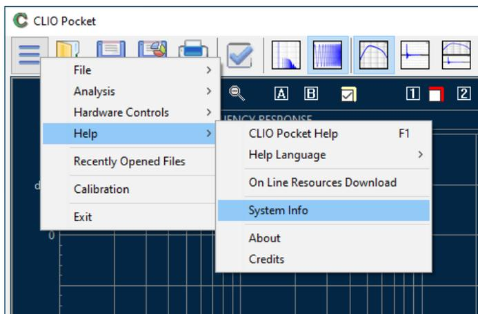
Nel caso in cui il vostro sistema non sia riuscito a completare la fase di calibrazione, si chiede di creare il file di informazioni di sistema **subito dopo** il fallimento della calibrazione.
