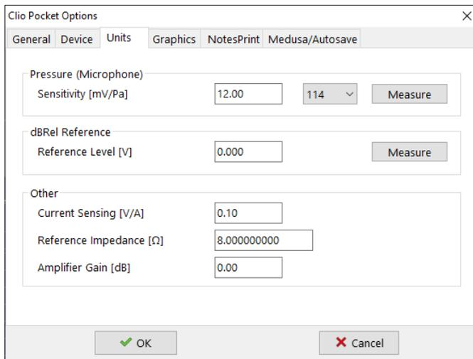
Per preparare CLIO Pocket alle misure in dB SPL occorre impostare la sensibilità del microfono in questa finestra; il valore è riportato nel certificato di calibrazione che viene fornito con il vostro microfono:
